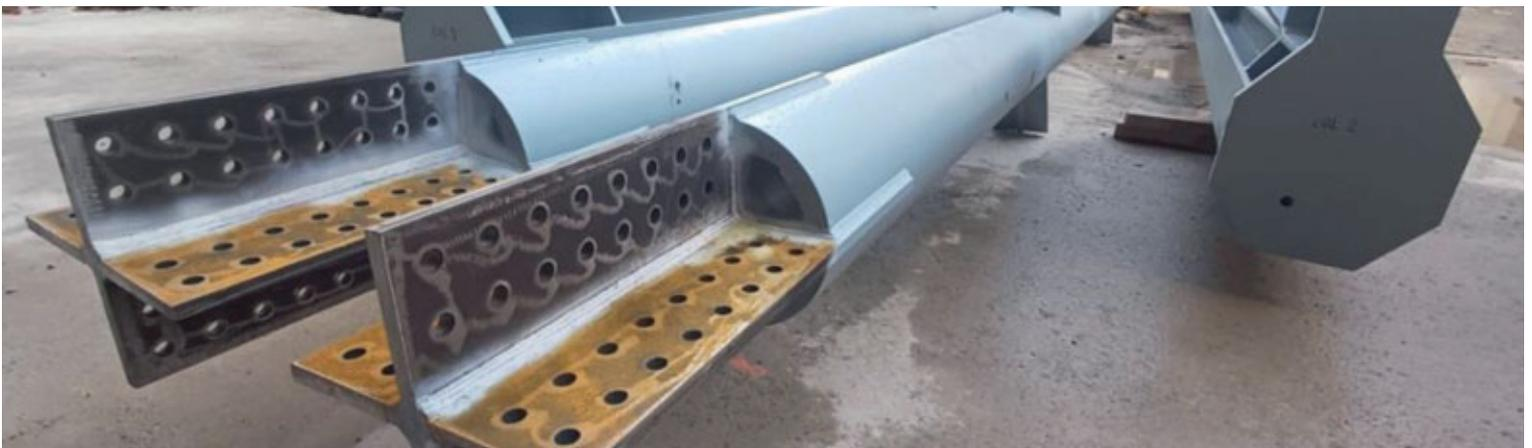
Fig. 26: Smistamento a terra diagonali e verifica dei risparmi di verniciatura con mascherine per giunti ad attrito.
