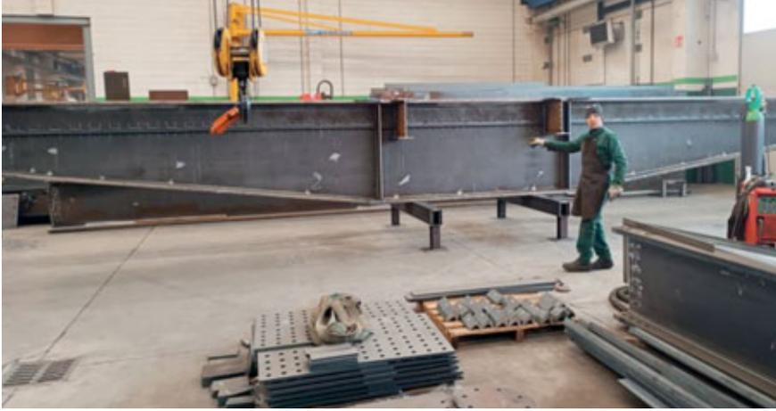
Fig. 22: Imbastitura della trave boomerang composta per piatti saldati.
