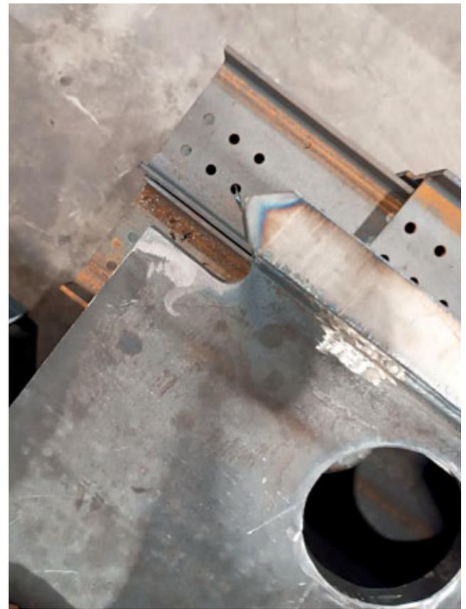
Fig. 23: Lavorazione di cianfrinatura a K per completa penetrazione da officina - Tronchetto attacco a coprigiunto trave boomerang.
