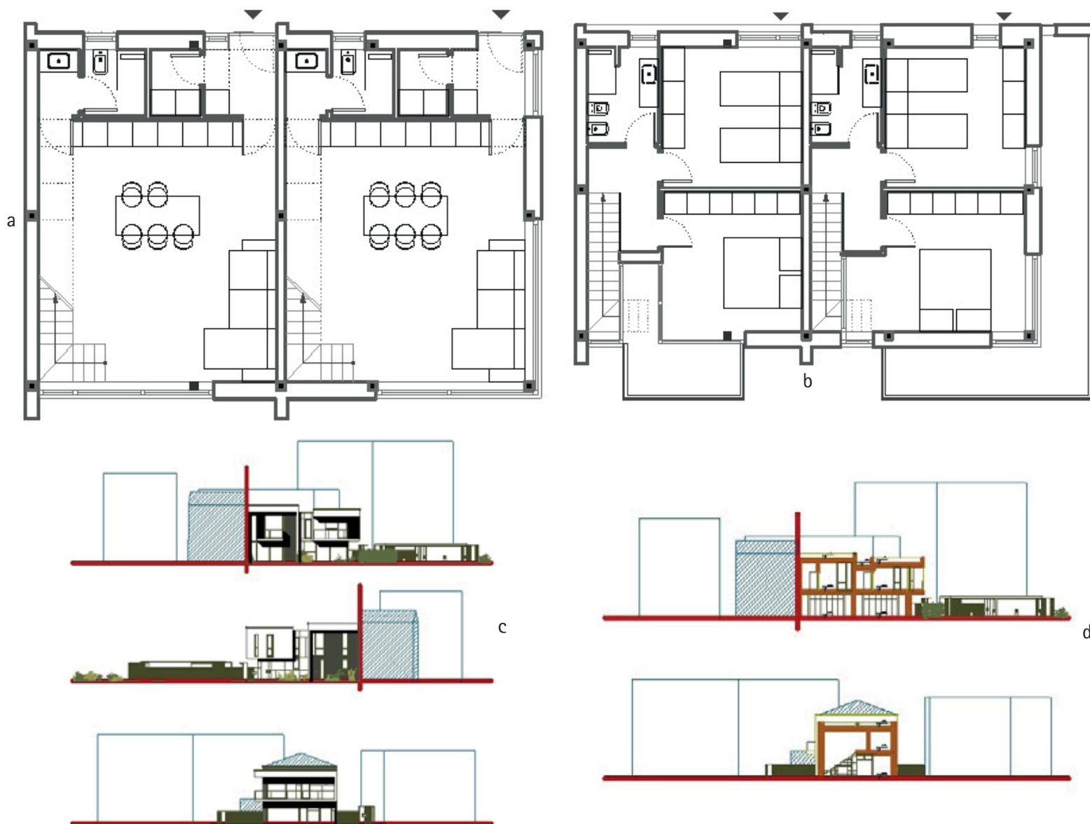
Fig. 2: Pianta del piano terra (a) e del primo livello (b), prospetti (c) e sezioni (d) dell'edificio.
