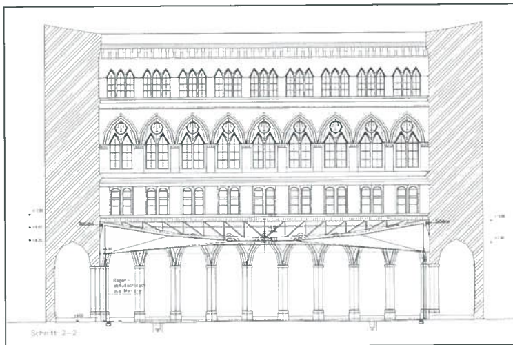
Figura 3 Sezione 2-2, parallela alle travi reticolari in acciaio con sezione triangolare rovesciata. La forma delle travi rastremate alle estremità trova rispondenza con l'andamento sinusoidale della membrana sottostante.
