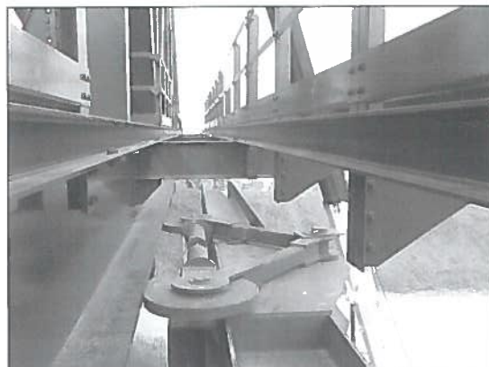
Figura 83 - Ruote di contrasto impegnate
