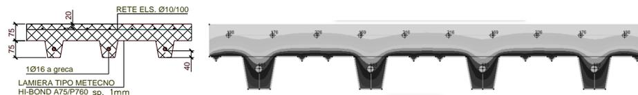
Fig. 8. Sezione della soletta di impalcato e Analisi termica in condizione incendio
