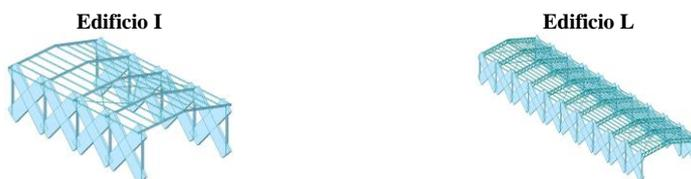
Fig. 3. Modelli ad elementi finiti delle strutture con pareti in muratura
