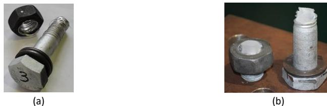
**Fig. 1.** Rottura di bulloni HV per pura tensione (a) e per azione combinata di taglio e flessione (b) in un flush end-plate bolted link
