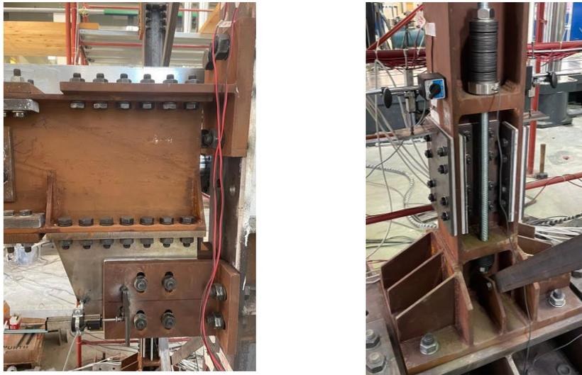
**Fig. 2.** Collegamenti dell'edificio testato: (a) Collegamento FREEDAM trave-colonna; (b) Giunto di base ricentrante e a basso danneggiamento
