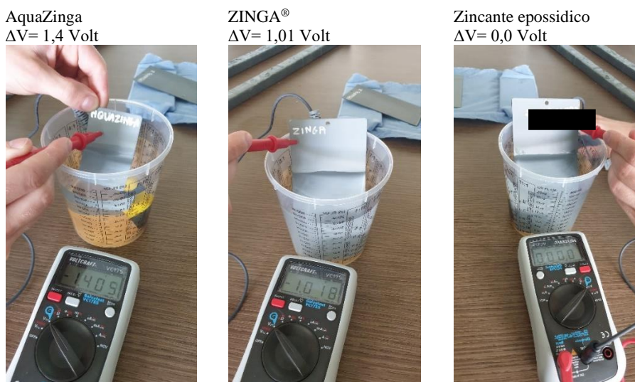
Fig. 1. Misura della differenza di potenziale tra acciaio e protettivo zincante secondo ASTM G215
