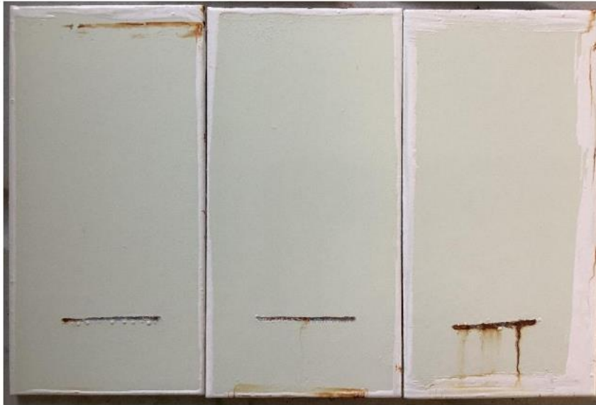
Fig. 5. campioni di Aquazinga + Sil-Epoxy dopo 1440 ore di test
