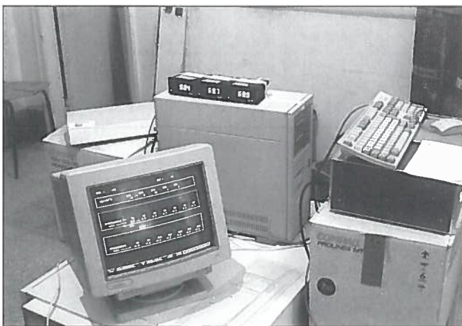
27. Apparecchiature centralizzate per le misure degli estensimetri elettrici e dei trasduttori di spostamento.
