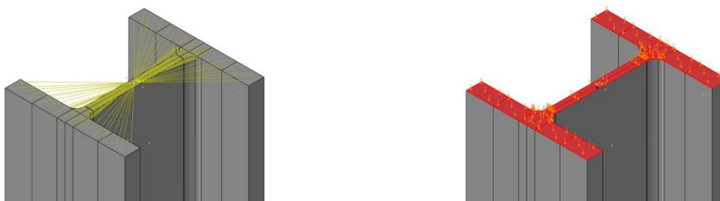
**Figura 23:** Coupling della faccia superiore della colonna ad un punto centrale vincolato esternamente ed applicazione di una pressione
