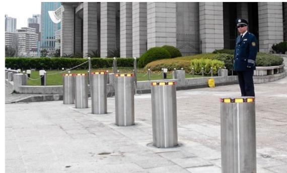
Figura 9. Sistema di bloccaggio azionato idraulicamente
