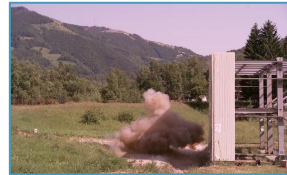
Detonazione di un'alta carica esplosiva vicino a un edificio (progetto SAFE-WALL, 2021)
