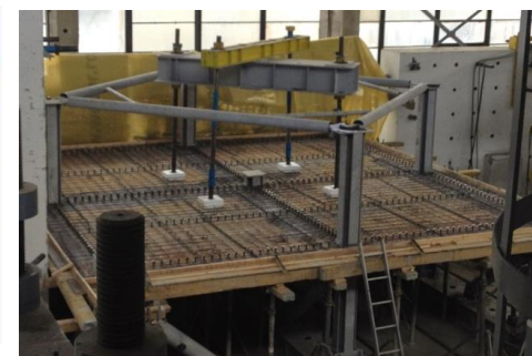
Campione sperimentale prima e dopo il getto della soletta in calcestruzzo
