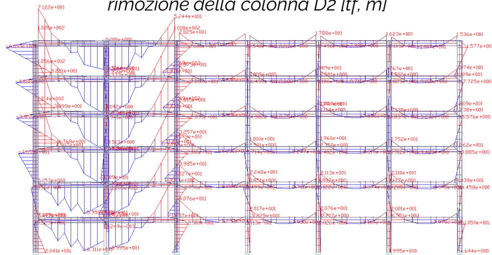
Diagramma dei momenti flettenti massimi dopo lo scenario di rimozione della colonna D2 [tf, m]
