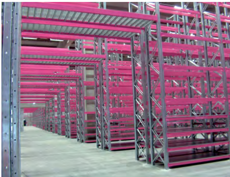
Fig. 3 - La certificazione EN15512:2009 rappresenta per il cliente una certezza di prestazione, di funzionalità, di sicurezza e di garanzia del proprio investimento fino ad oggi non disponibili con garanzia ufficiale di parte terza; per i Costruttori rappresenta il primo dei processi di certificazione di prodotto che si renderanno disponibili nei prossimi anni e che riguarderanno tutti i sistemi di scaffalature
