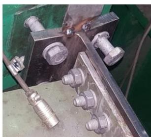
Figura 5.13 – Collasso della connessione a T superiore
