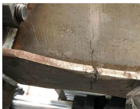
c) Crisi della saldatura della connessione RBS 1A
