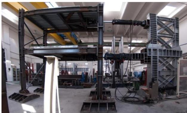
a) Telaio con connessioni RBS
