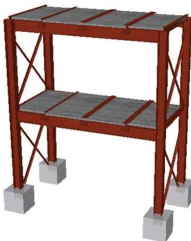
Figura 6.22 – Modello 3D del campione con connessioni RBS
