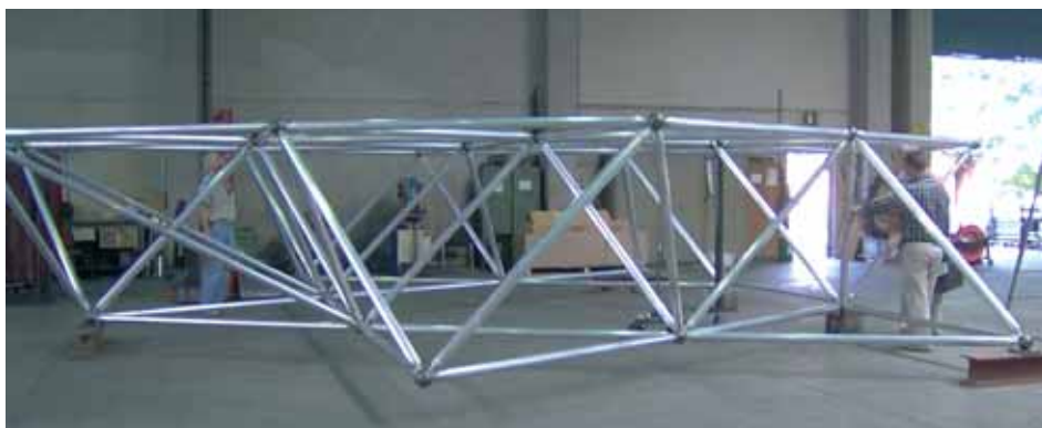
Fig. 6.2 - Modello per prova di carico
