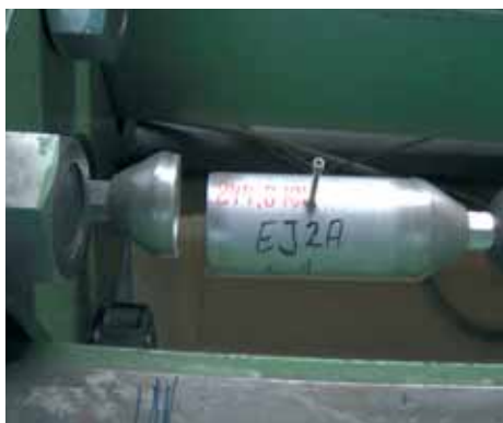
Fig. 6.1 - Prova di trazione giunto
