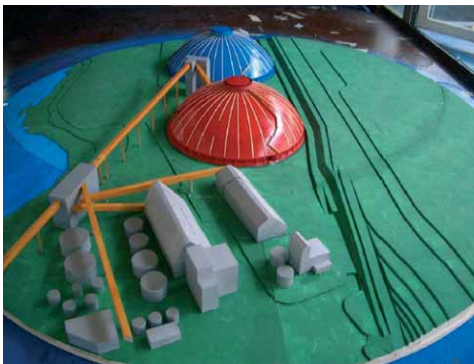
Fig. 4.4 - Modello in galleria del vento
